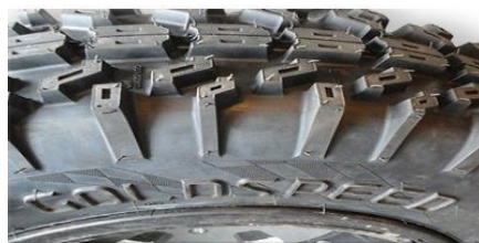
Dit profiel ook niet toegestaan
