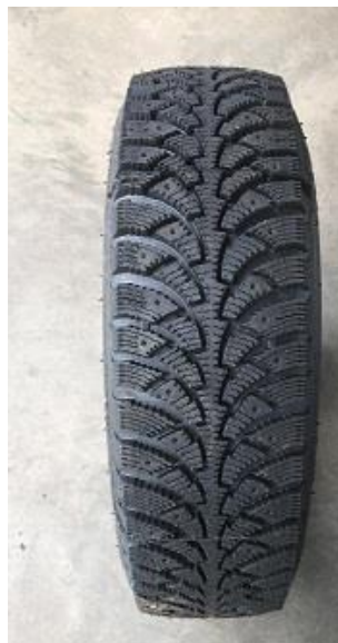
Opgesneden in V Profiel
